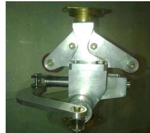
Banc d'essai "Lever à rayon variable" pour la commande du Lacet sur concept X3
